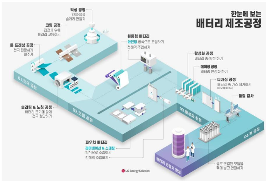
그림 1. 배터리 제조용 소재, 공정 및 제품(소자) 개념도
