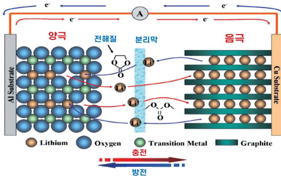
그림 3. 리튬이온 이차전지의 구조 및 작동원리.
