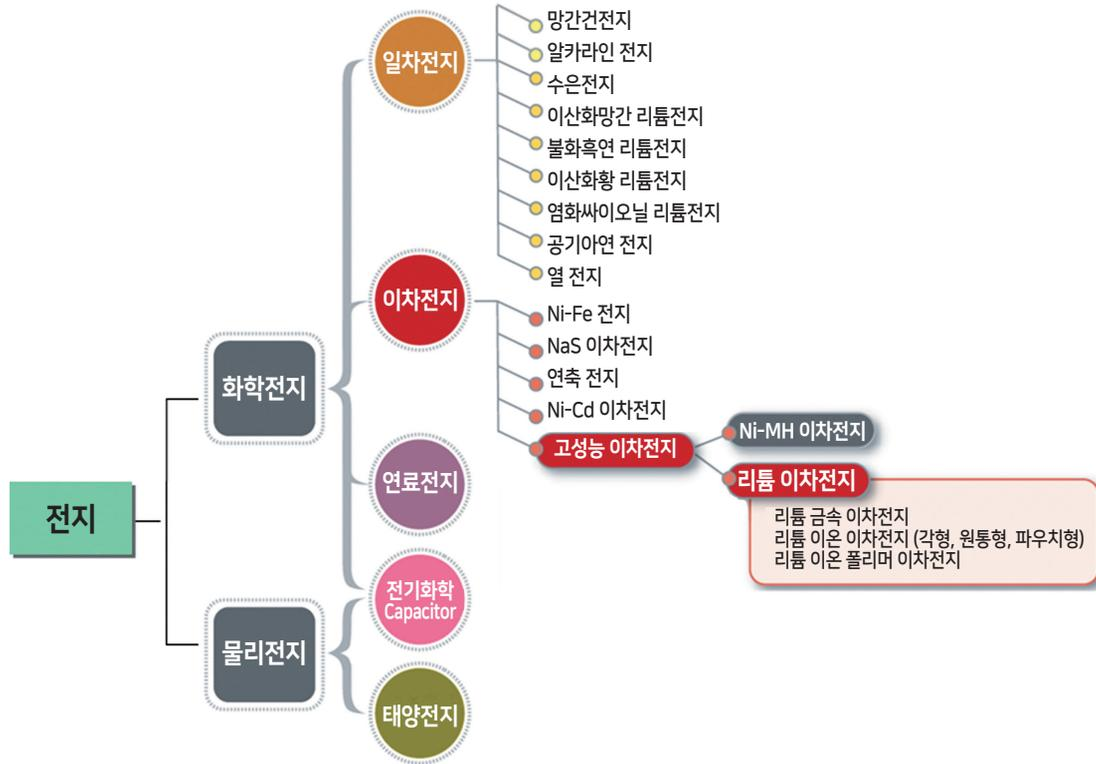
그림 2. 전지의 분류 및 배터리(화학전지)의 종류.
